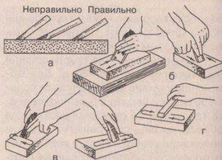
Рис. 27. Заточка ножей рубанка и стамесок: а — установка ножа на бруске; б — заточка на бруске; в — правка на оселке; г — снятие заусенца с передней грани ножа
